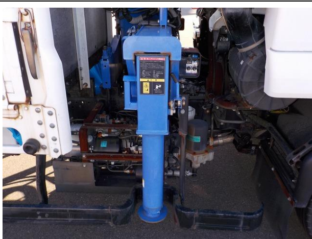
クレーン操作部(運転席側)
