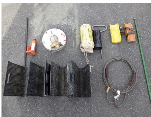
ダルマジッキ、ディスクストレーナー、ストレーナー、藤かご、マンホール開閉具、枕木×2、金てこ棒、ワイヤチェン、ホースブリッジ×2
